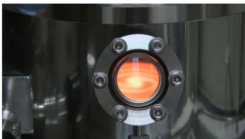
独自の基板高速回転機構をもつ酸化亜鉛用 MOCVD 試作機の成長炉 (加熱中)
