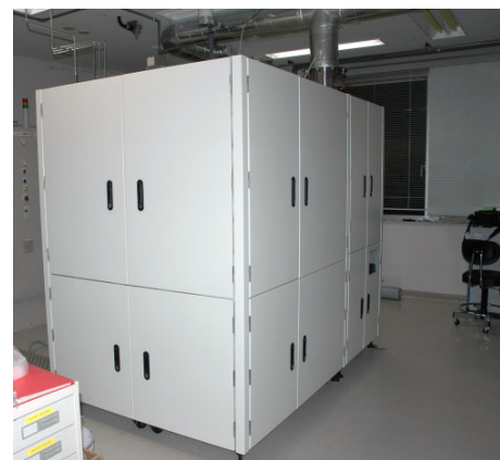
酸化亜鉛用 MOCVD 試作機
