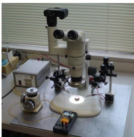
図1 マニピレータ・スポット溶接装置
