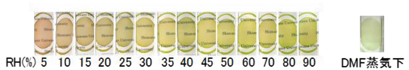
Fig. 4 各相対湿度における薄膜の色調変化(左)と DMF 蒸気下における薄膜の色調(右)
